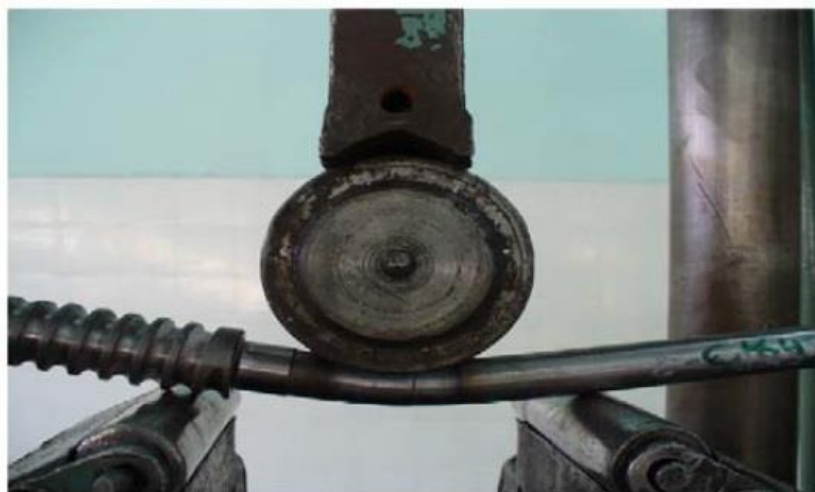
شکل (۱): نحوه انجام آزمون خمش
